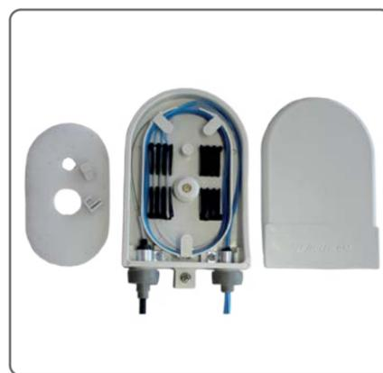
Produto leve e de fácil instalação utilizado para terminação óptica, fazendo a transição entre o cabo e a extensão óptica através de fusão. Possui 2 entradas de cabos, protegidas por borrachas tampão. Acomoda até 12 emendas ópticas no compartimento interno. Utilização indoor.
