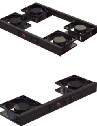
Desenvolvido para auxiliar no resfriamento dos equipamentos instalados nos racks. Produto instalado na parte superior dos Racks de Piso ou Parede. Ventiladores duplos ou quádruplos com vazão de 43 a 50 l/s, dependendo da tensão da rede selecionada. É fornecido com cabo de alimentação (3 x 0,75mm<sup>2</sup>), com comprimento de 1,5m e tomada padrão NBR 14136-2002 na ponta.
