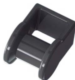
Utilizado para suspensão ou ancoragem de cabos DROP F8 em vãos de até 80 metros, utilizando abraçadeira BAP ou cinta de INOX 3/4" com fecho. Por ser produzido em peça única, com tamanho e peso reduzidos, proporciona facilidade e praticidade na instalação.
