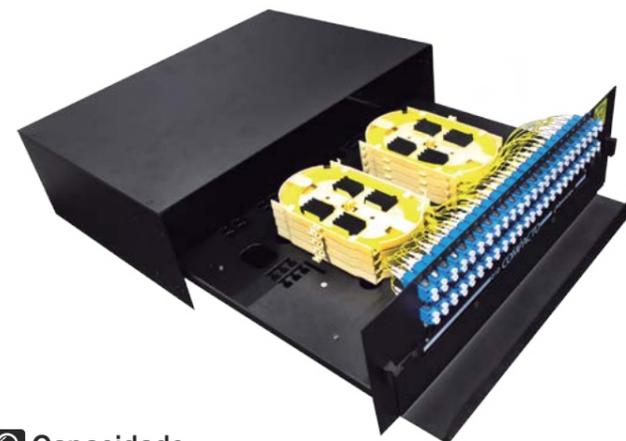
O DIO Compacto tem estrutura modular padrão 19/23" (rotação de suporte de fixação), acomoda até 72 fibras (ou 144 LC duplex) distribuídas em uma única gaveta deslizante com painel frontal metálico para acomodação dos adaptadores. Com sistema de ancoragem do cabo e do elemento de tração, compartimento individual para sobra de tubo loose e entrada de cabos traseira. O modelo de 3U possui um berço frontal para acomodação da saída dos cordões.
