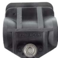
Produto utilizado para suspensão de cabos autossustentados em postes em trechos em linha reta com desvio máximo de 20° e vão máximo de 120 metros, suporta carga de até 25kg. Estrutura bipartida plástico de engenharia de alta resistência (PP), insertos de borracha aditivada vulcanizada, parafuso sextavado e arruelas m8 em aço inox.
