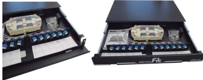
O DIO EASY FIT possui as mesmas facilidades do modelo DIO FIT e ainda tem o diferencial da tampa frontal ser basculante, facilitando o acesso para manutenções da rede óptica. Com 1U de altura comporta 24 fusões. Estrutura padrão 19/23" (rotação de suporte de fixação) com gaveta deslizante e frente basculante com imã para trava.
