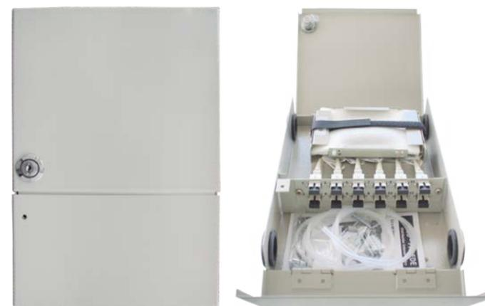
DIO Parede acomoda até 96 fibras distribuídas em módulos metálicos internos com capacidade para 12 emendas cada. Possui duas portas de acesso, uma para distribuição fechada com parafuso M4 e outra para acesso às emendas com fecho à chave.
