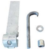
As abraçadeiras BAP ajustáveis são utilizadas na rede aérea para a sustentação de acessórios em postes. Faixa de diâmetro indicado para instalação: BAP 1- até 127mm | BAP 2- até 254mm | BAP 3- até 350mm | BAP 4- até 320mm.
