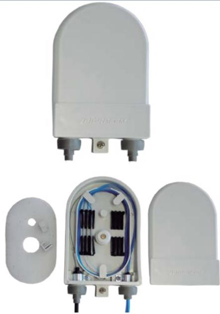
Acessório utilizado para terminação óptica, fazendo a transição entre o cabo e a extensão óptica através de fusão. Possui 2 entradas de cabos, protegidas por borrachas tampão escalonadas de 15mm de diâmetro. A quantidade de protetores de emenda 60x1mm fornecidos varia de acordo com a quantidade de fibras solicitada, 6 ou 12. Produto leve de fácil instalação.
