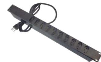
Régua com 10 posições desenvolvida para atender a norma ABNT NBR 14136:2012. Fixação em Racks Padrão 19", indicada para conexão elétrica aterrada de equipamentos eletrônicos. Possui condutor interno de latão, com secção transversal mínima de 2,5 mm<sup>2</sup> em toda sua extensão. É fornecida com cabo de alimentação de 3x1,5mm<sup>2</sup> com 1,5m.
