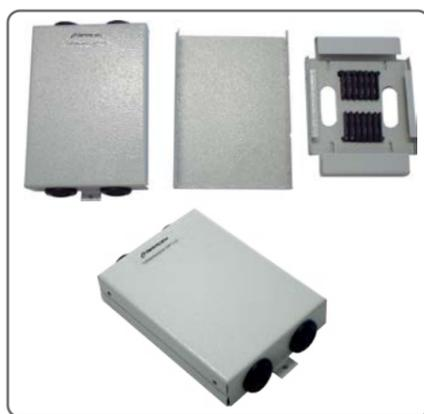
Acessório utilizado para terminação óptica, fazendo a transição entre o cabo e a extensão óptica, através de emenda por fusão. Acomoda até 12 emendas ópticas na bandeja interna onde também devem ser fixados os cabos, tampa com fechamento via parafusos M4. As entradas de cabos são protegidas com 4 tampões de vedação. Utilização indoor.
