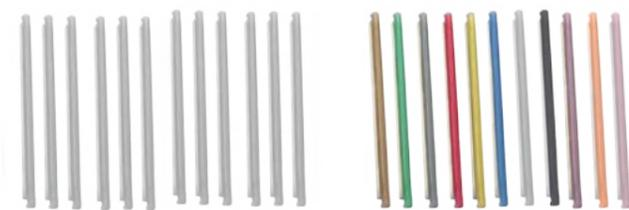
Proteção para as emendas ópticas. Composto de uma haste de aço inoxidável, um tubo plástico interno e um tubo de plástico externo termocontrátil.
