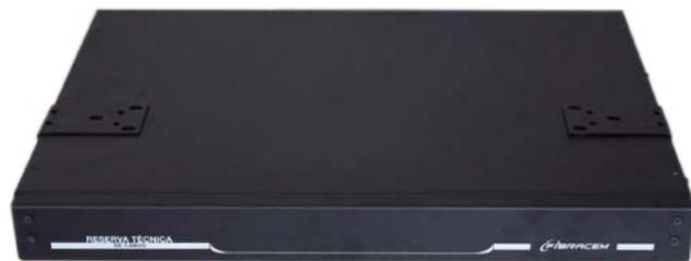
Acessório projetado para acomodação e reserva técnica do comprimento excedente de cordões e cabos ópticos para melhor organização do cabeamento nos gabinetes. Estrutura modular padrão 19/23" (rotação de suporte de fixação). Possui argolas para organização dos cordões na bandeja interna para evitar o estrangulamento, possui duas entradas laterais com dimensões de 29x27mm.
