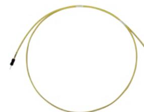
O cordão falso é utilizado no Derivador Óptico sem a necessidade de fusão de emenda. É constituído por tubo interno de PVC, revestido de fibra aramida e recoberto por uma capa plástica de PVC. Fornecido na cor amarela. Comprimento padrão 1,10m.
