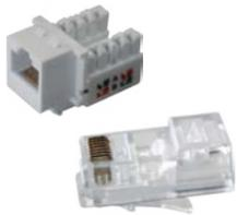
Os Keystones Jack Fêmea fazem a terminação dos cabos horizontais e disponibilizam facilidades nas estações de trabalho. Podem ser instalados nas tomadas de sobrepôr, caixa sistema X ou nos painéis de distribuição (patch panel descarregado). O conector macho é utilizado para terminações de Patch cable e Adapter cable.
