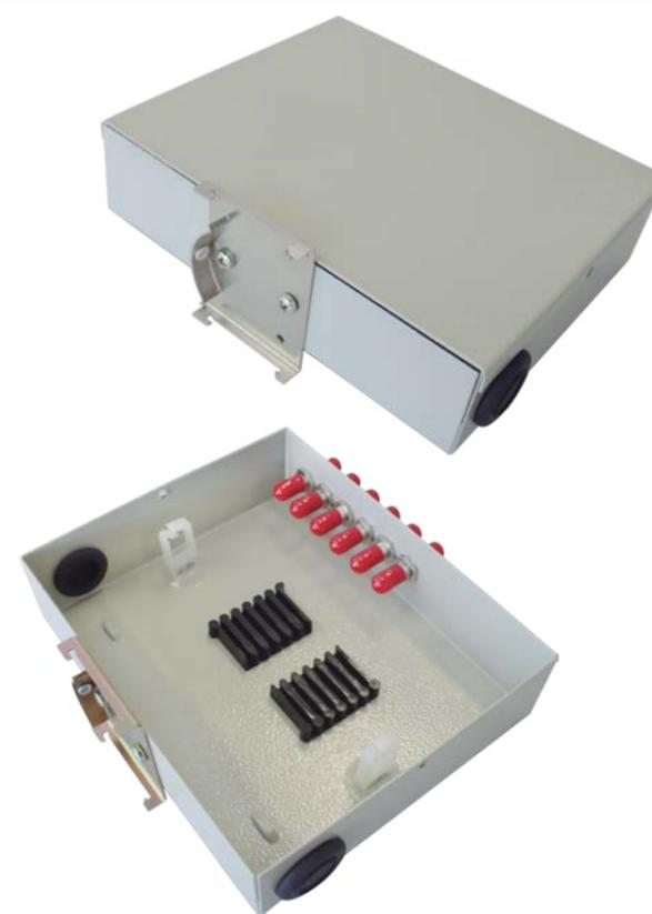
Acessório para fixação em trilho DIN TS35 indicado para acomodação, fusão e distribuição de fibras ópticas (SM, MM62,5, MM50, OM3 e OM4), indicado para instalação em painéis elétricos com interfaces ópticas. Acomodação de tubo loose em compartimento compartilhado, sem inclinação no painel de adaptadores e entradas de cabos superior e inferior. Compacto, ideal para pequenas derivações.
