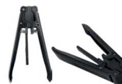
Ferramenta específica para retirar com segurança a capa externa de cabos ópticos DROP MINI (3x2mm), expondo a fibra para fusão ou conectorizações com conector pré-polido. Para decapagem do DROP MINI é necessário abrir manualmente e cortar o arame que serve de sustentação no lançamento aéreo. Ferramenta essencial para instaladores e provedores de internet.
