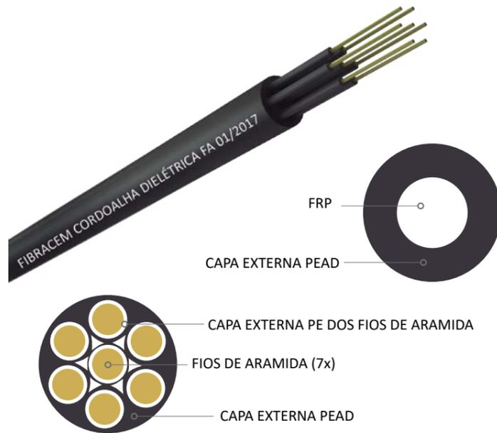
Fabricada pela Fibracem, é utilizada para sustentar cabos ópticos ou telefônicos em redes aéreas. Por ser dielétrica, a cordoalha dispensa aterramentos e ferramentas especiais para corte. Além de ser mais leve, permite uma instalação mais rápida e fácil em relação à cordoalha de aço. Possibilidade de compras pelo BNDES. Embalada em rolos de 500 metros.
