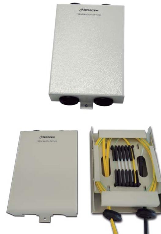
Acessório utilizado para terminação óptica, fazendo a transição entre o cabo e a extensão óptica, através de emenda por fusão. Acomoda até 12 emendas ópticas na bandeja interna onde também devem ser fixados os cabos, tampa com fechamento via parafusos M4.
