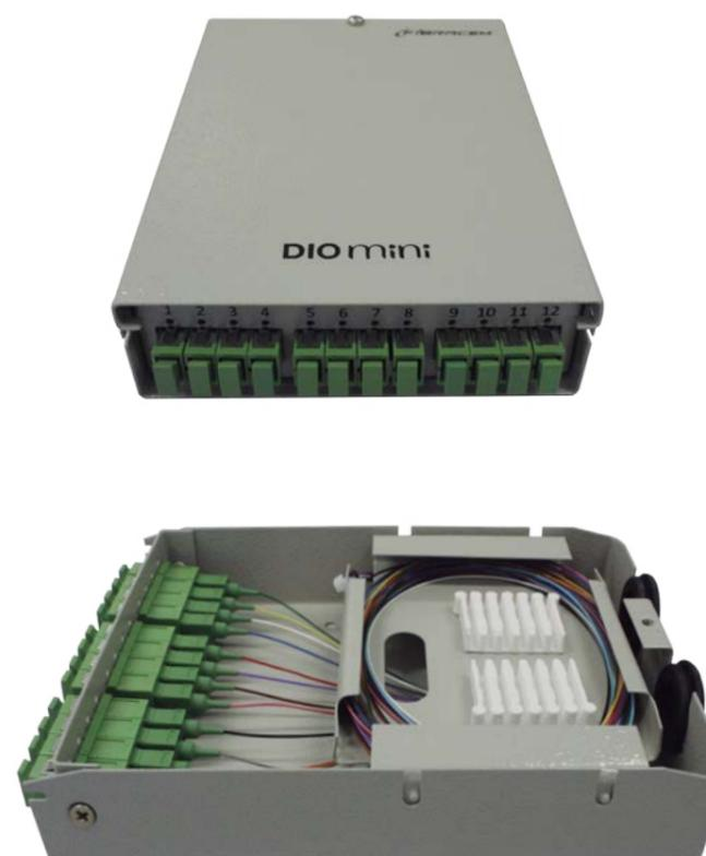
Acessório de fixação em parede utilizado para acomodação, fusão e distribuição de fibras ópticas (SM, MM62,5, MM50, OM3 e OM4) para baixa densidade de cabeamento. Acomodação de tubo loose compartilhada, sem inclinação no painel de adaptadores e entrada de cabos superior. Compacto, ideal para poucas terminações. Possui borracha tampão para vedação da entrada de cabos.
