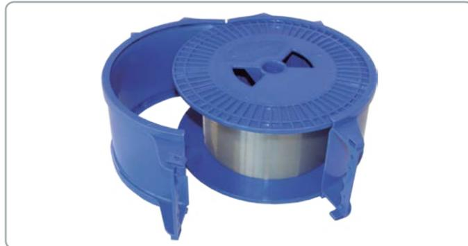
A fibra de lançamento é utilizada para auxiliar as medições com OTDR. Possibilita a medição com o sinal já estabilizado no link (livre da "zona morta" do OTDR). Pode ser adquirida com ou sem conectores nas extremidades. É fornecida em bobina plástica com alça para transporte.
