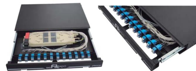
O DIO FIT MPO tem estrutura padrão 19/23" (rotação de suporte de fixação) e gaveta deslizante com corredeira telescópica com 250mm de abertura, permite a fixação de adaptadores ópticos ou de cassetes MPO. Bandejas plásticas articuláveis com capacidade de 24 emendas cada, possibilidade de até 48 fibras em 1U quando utilizado adaptador LC Duplex.
